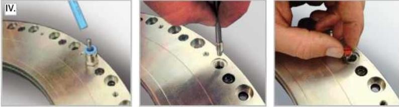
■ 작동압력(4 또는 6bar)으로 RotoClamp 내부에 압력을 가합니다. RotoClamp Inside의 평면 접점과 부착 영역 사이의 »OPEN« 및 »CLOSE« 연결부에 O 링을 삽입합니다. RotoClamp를 원하는 위치(관찰자 쪽)에 설치한 다음 공기 공급을 차단합니다. 그런 다음 공압 연결부와 설치 핀을 제거합니다.
