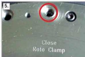
■ 중요: RotoClamp Inside with additional air option (booster) - 압축 공기를 »CLOSE« 연결부에 연결하고 견고성과 올바른 기능을 검사합니다.
